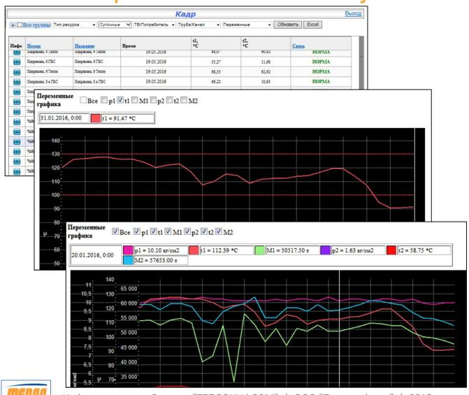
Значения параметров точки учета по результатам последнего считывания по данным часового, суточного опроса, а также текущего опроса отображаются в интерфейсе «Кадр».
